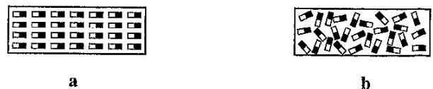
Figura 10.3. Moléculas magnéticas de un imán (a) y de un trozo de hierro (b).
