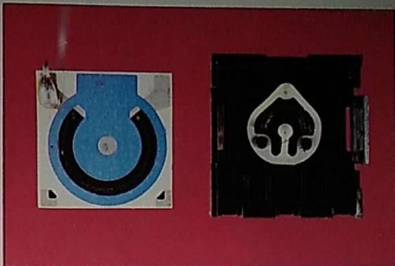
Potenciómetro cermet. La fotografía muestra la caja con el cursor a la izquierda y la cerámica con la pista resistiva a la derecha.
