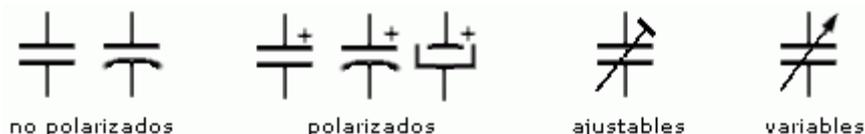
*Nota:* al implementar circuitos, no olvidar respetar las indicaciones de los terminales en los capacitores polarizados para evitar su destrucción.
