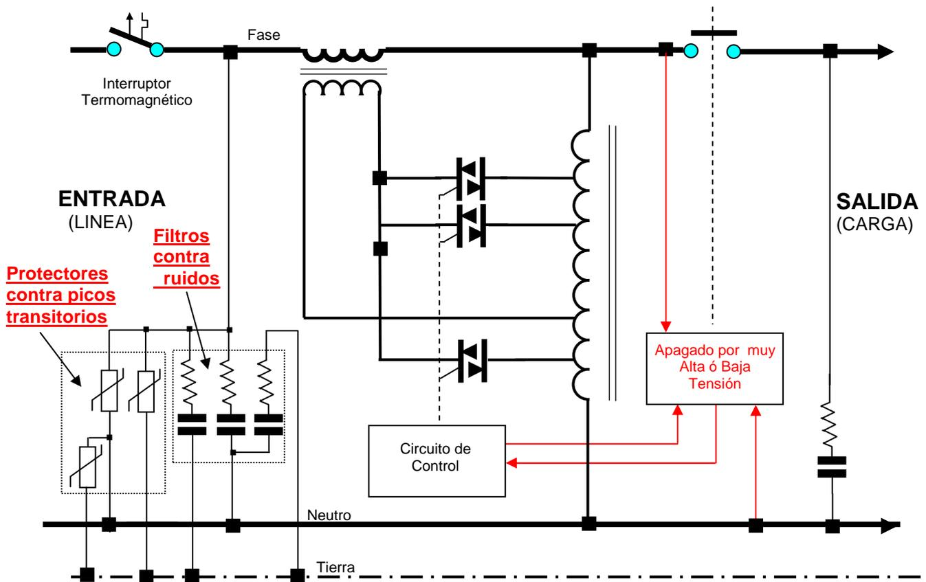
**Fig. 7-8 Estabilizador Electrónico Tipo Booster**
