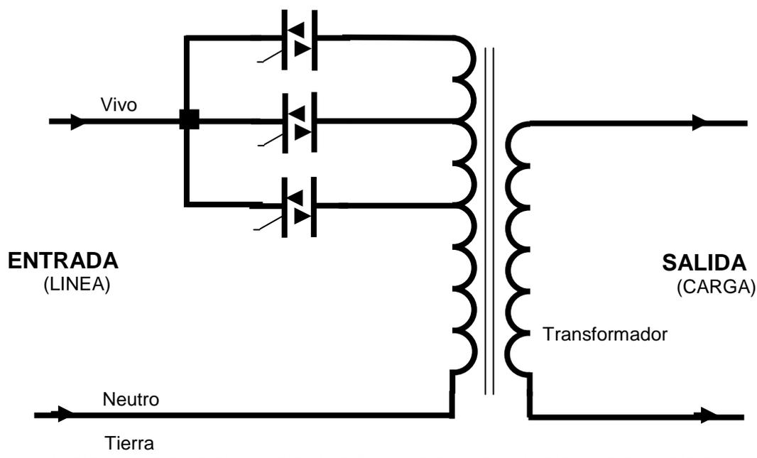
**Fig. 7-9 Estabilizador con Transformador Separador incorporado**
