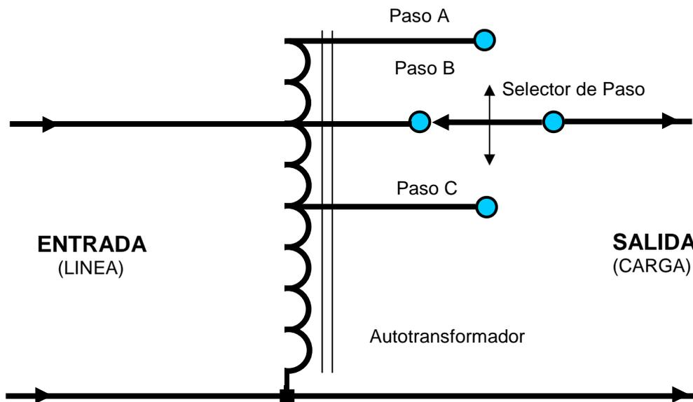
Fig. 7-1 ESTABILIZADOR POR PASOS (Esquema circuitual)
