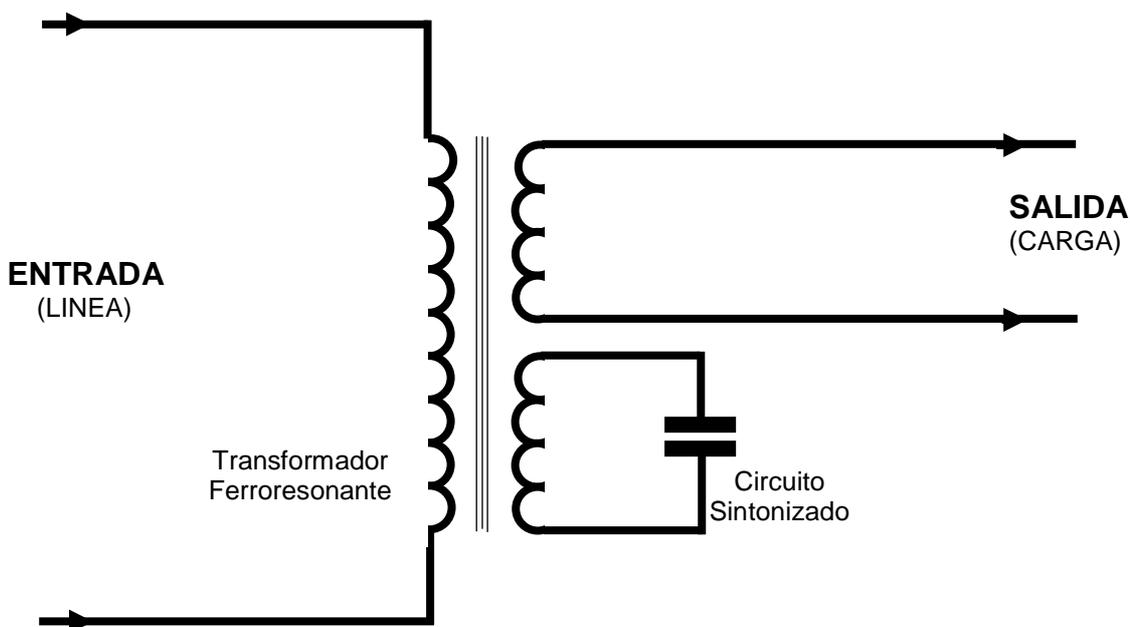
**Fig. 7-11 Estabilizador Ferroresonante**
