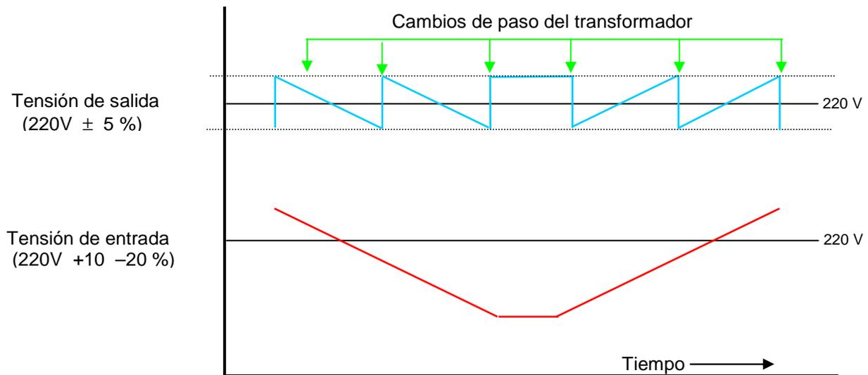
**Fig. 7-6 Estabilizador por Pasos / Ejemplo de la Regulación**
