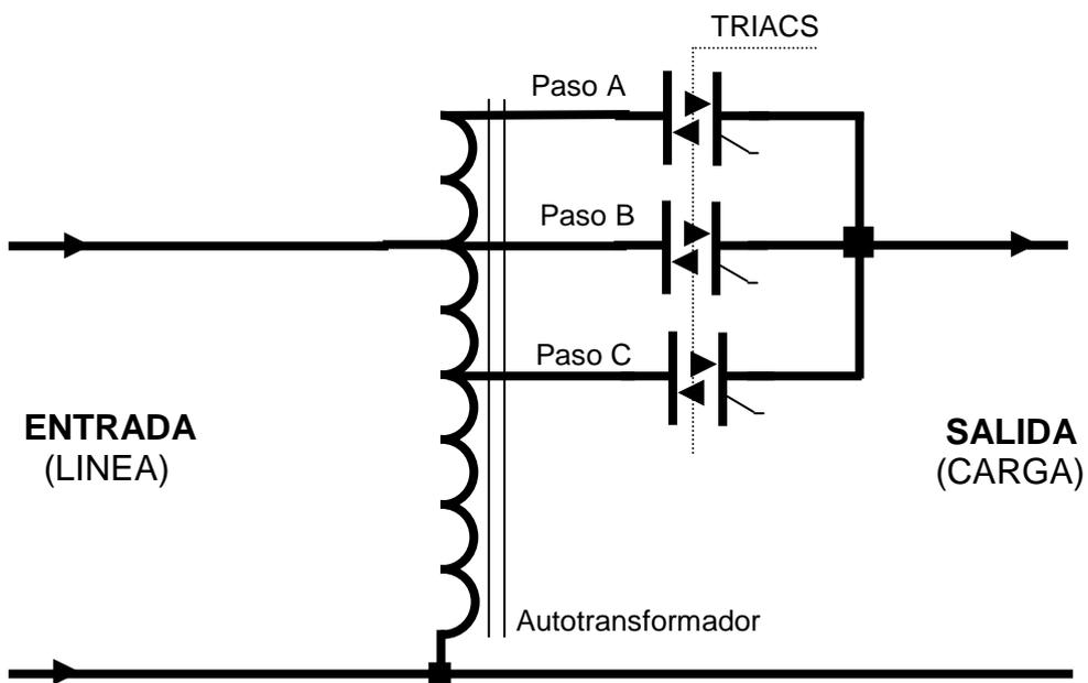
Fig. 7-5 Estabilizador Electrónico con Triacs
