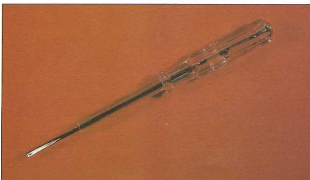
Para emplearlo como buscapolos es necesario introducir la punta en el enchufe y tocar con el dedo la zona metálica de la parte trasera del mango. El polo activo de la red producirá el encendido de la luz de neón interna
