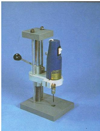
Modelo de máquina de taladrar miniatura, montada sobre un soporte vertical. Puede observarse el brazo con esfera negra que realiza el descenso y ascenso de la máquina sobre el material que se sitúe en la base
