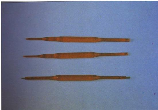
Juego de tres destornilladores para ajuste. El inferior dispone de punta metálica en ambas puntas
