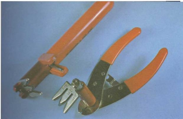
Dos formas diferentes de alicates de pelar, aunque ambos realizan la misma función. El decapado lo realizan únicamente sobre cables de dos diámetros fijos, insertándole sobre la herramienta en forma de W que se observa en primer plano. También permiten el corte de cables
