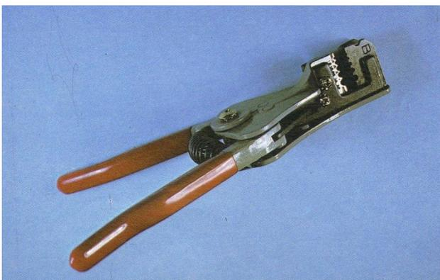
Tenaza de pelado para varios diámetros de hilo (seis en este modelo). Basta con insertar el cable en el orificio que le corresponda y ejercer una determinada fuerza sobre los brazos para conseguir el decapado
