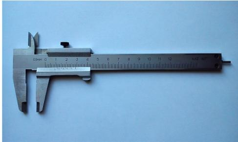
Calibre para medidas de exteriores e interiores. El resultado de la medida se obtiene leyendo el valor representado por la raya situada sobre el cero del brazo móvil
