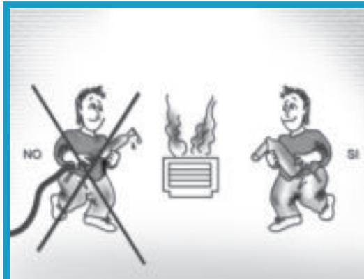
Forma correcta de apagar incendios en aparatos eléctricos (con extintores de nieve carbónica)
