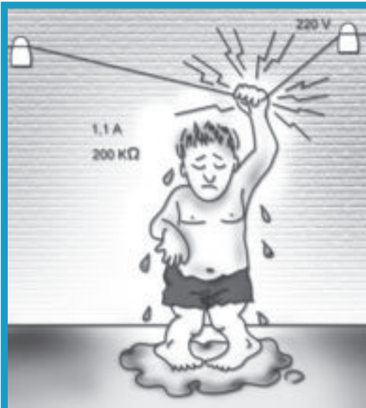
Mal aislamiento (piel mojada)
