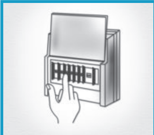
Desconecte el interruptor general de la rama en cuestión
