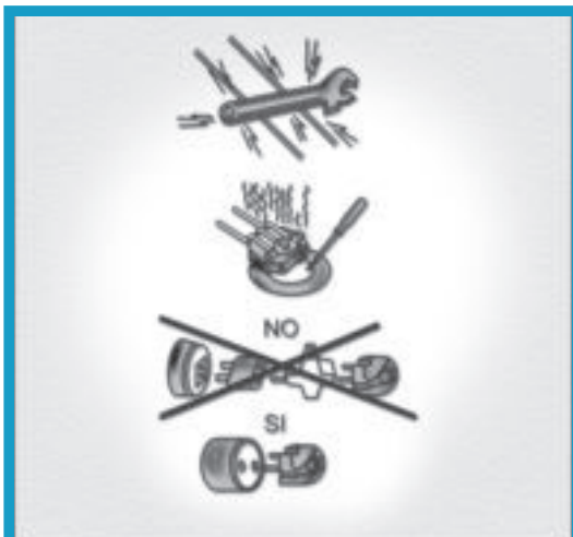
Causa de incendios: cortocircuitos, calentamiento excesivo, malos contactos
