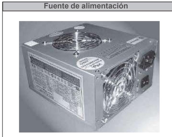
La función básica de una fuente de alimentación consiste en rectificar la tensión alterna del toma corriente (220V) a tensión continua y generar los voltajes requeridos para el funcionamiento de los dispositivos de la PC.
