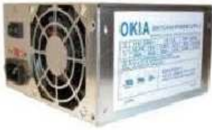
Figura 2. Imagen de una fuente de poder ATX, marca Okia®, modelo Broadway para 400 Watts, con interruptor mecánico trasero y frontal digital.
