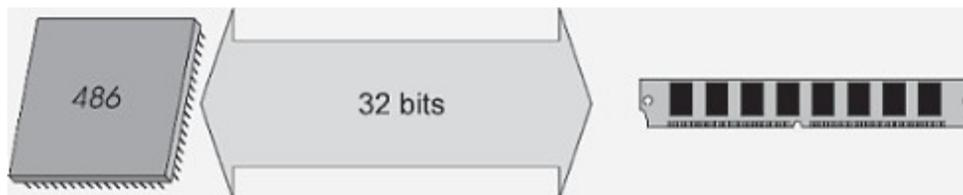
A partir de los CPU que manejan un ancho de bus de 64 bits, para equiparar esta cantidad de bits, será necesario colocar dos módulos SIMM de 72 contactos para reunir 64 bits.
