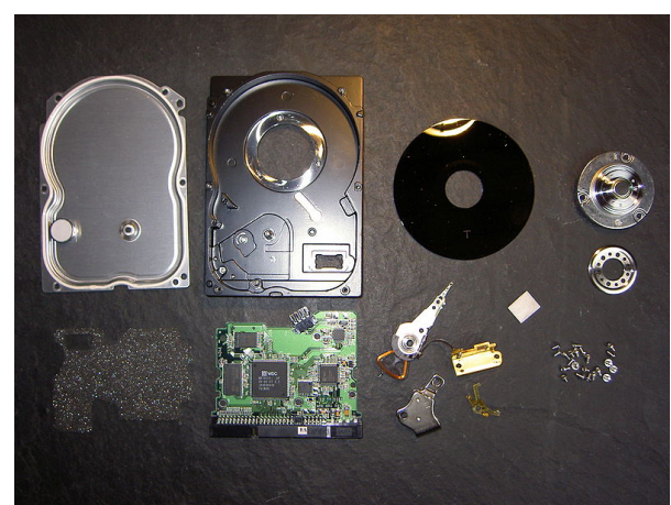
Componentes de un disco duro . De izquierda a derecha, fila superior: tapa, carcasa, plato, eje; fila inferior: espuma aislante, circuito impreso de control, cabezal de lectura / escritura, actuador e imán, tornillos.
