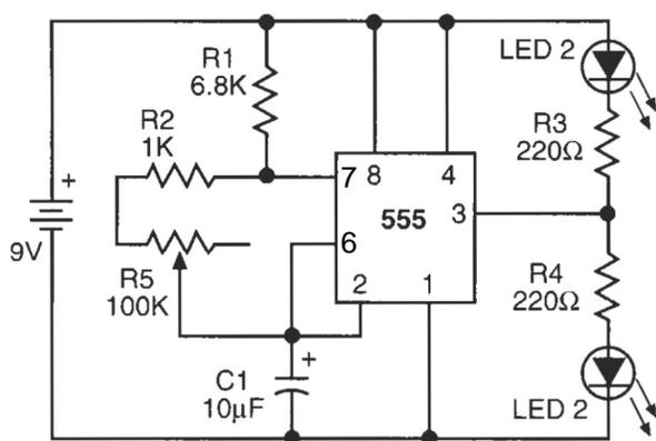
**Figura 2.1 Diagrama esquemático.** El circuito integrado 555 actúa como elemento central del circuito. El valor del condensador C1 (10 µF), del potenciómetro R5 (100K) y de la resistencia R1 (6,8K) determinan la velocidad de encendido y apagado de los LED. Las resistencias R3 y R4 sirven para limitar el valor de la corriente que circula a través de los LED. Su valor es de 220 Ω (rojo - rojo - café - dorado).
