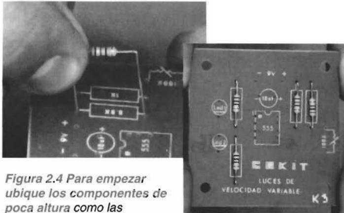
**Figura 2.4** Para empezar ubique los componentes de poca altura como las resistencias. Las técnicas de soldadura correctas se explican en la sección de **Electrónica Práctica del Curso Básico de Electrónica Moderna**.
