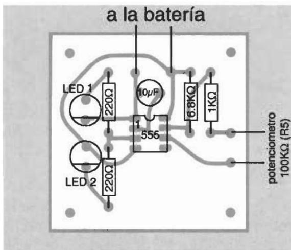
**Figura 2.3 Guía de ensamble y circuito impreso.** Se debe tener mucho cuidado para ubicar los componentes en forma correcta ya que los LED, el condensador electrolítico y el circuito integrado tienen una posición definida; si esta labor no se hace correctamente se puede dañar el componente.
